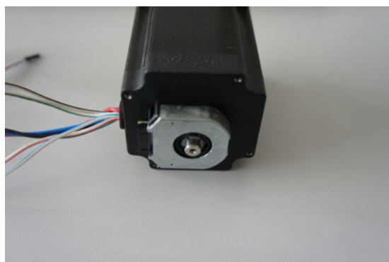
Рис. 3.9: Мотор с прикрепленным энкодером
