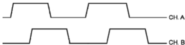
Рис. 4.19: Сигналы на выходе CH A и CH B квадратурного энкодера
