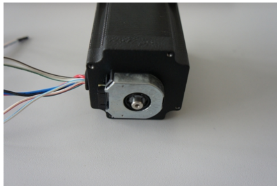
Рис. 3.11: Двигатель с прикрепленным энкодером
