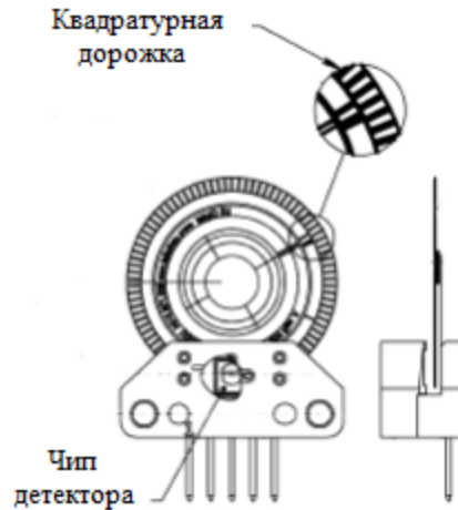
Рис. 4.24: Механика оптического квадратурного энкодера
