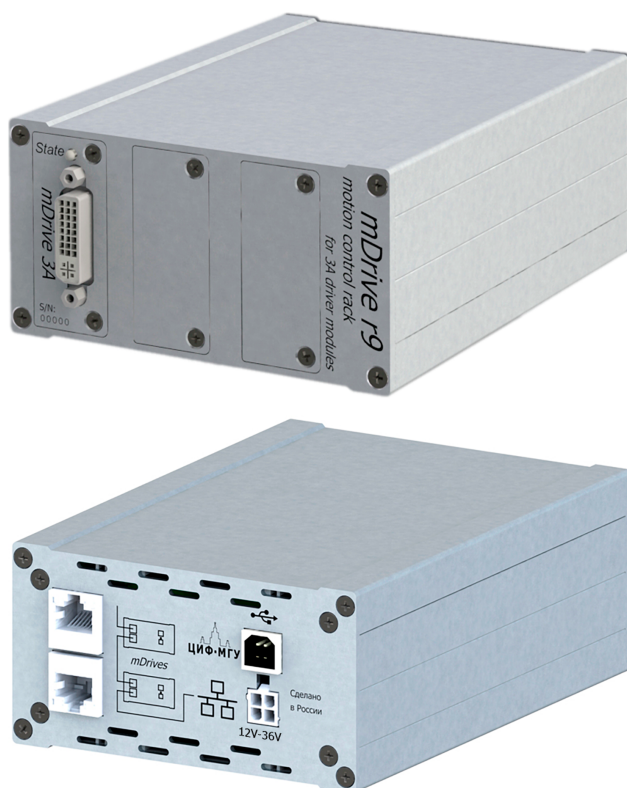
Рис. 4.4: Внешний вид одноосного контроллера mDrive
