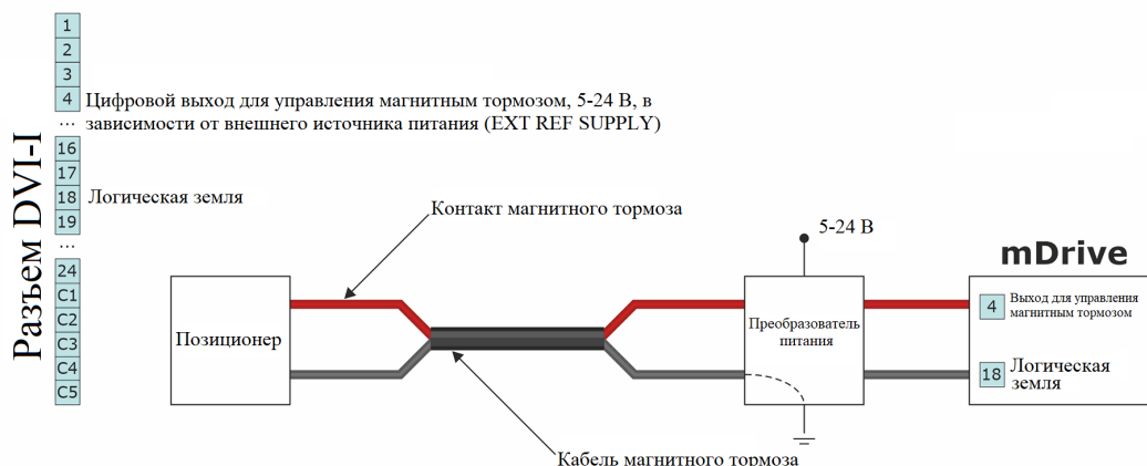
Рис. 4.30: Схема подключения магнитного тормоза к контроллеру mDrive
