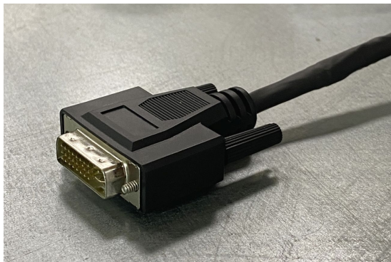
Рис. 3.17: Готовый провод, соединяющий двигатель с DVI-I разъёмом
